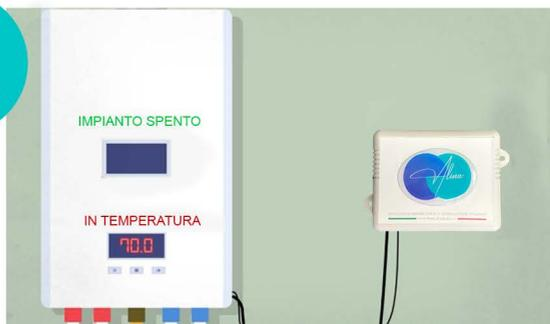
Quando l'acqua dei termosifoni è arrivata a temperatura, Alina spegne la caldaia e la pompa elettrica di circolazione fino a che l'acqua non ha davvero bisogno di essere nuovamente riscaldata, dando il tempo all'acqua calda presente nei termosifoni di cedere il proprio calore all'ambiente.
