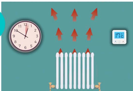
Se in casa, ad esempio, abbiamo 17° e vogliamo arrivare a 20°, ci vorranno almeno 2 ore per raggiungere la temperatura desiderata: in tutto questo tempo la caldaia riscalda inutilmente acqua già calda e consuma energia elettrica per far circolare inutilmente e continuamente l'acqua nell'impianto, facendole disperdere calore.
